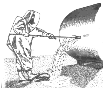
Рис. 5. Затискання пробоїни пневматичною заглушкою
