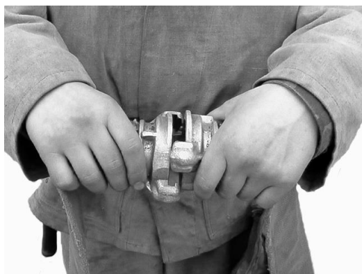
Рисунок 5.3 – З'єднання головок типу Богданова
