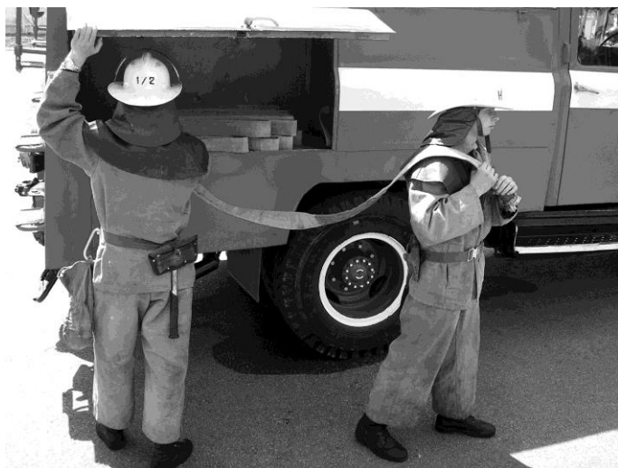
Рисунок 5.5 – Прокладка рукавної лінії з рукавів, покладених «гармошкою»
