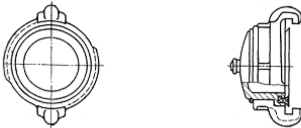
Рисунок 6.5 – Будова головки-заглушки (пожежної)
