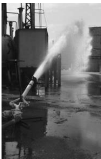
Рисунок 8.5 – Робота СЛК-П20А з насадком Ø 32 мм
