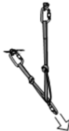
Рисунок 4.34 – Робота компенсуючої петлі при зміні напрямку навантаження
