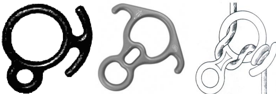
Рисунок 2.12 – Спусковий пристрій «Рогатка»
