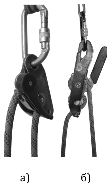
Рисунок 7.3 – Використання страхувальних пристроїв фрикційного типу в якості гальмівного пристрою в АГС:
