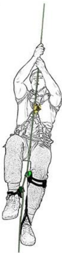
Рисунок 6.2 – Спосіб підйому «коліно-стопа»
