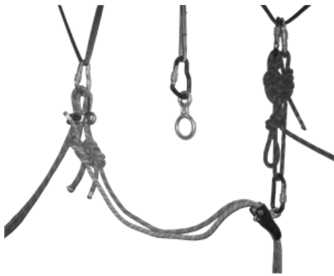
Рисунок 7.8 – Перенесення навантаження на страхувальний пристрій додаткової страховки
