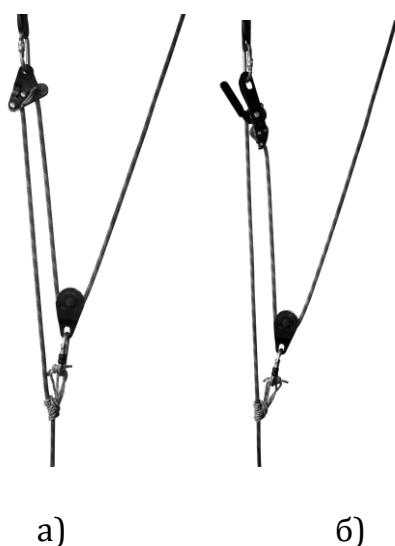
Рисунок 7.22 – Використання автоматичних страхувальних пристроїв для автоматичної фіксації поліспаду:
