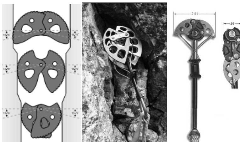
Рисунок 4.25 – Принцип встановлення та роботи «френдів» та «камалотів»
