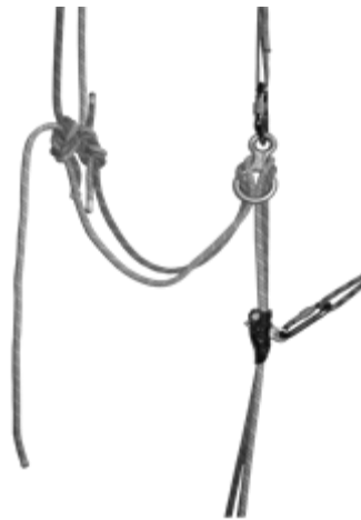
Рисунок 7.6 – З'єднання спускових канатів на вирівнювання довжини їх кінців вузлом «зустрічна вісімка»
