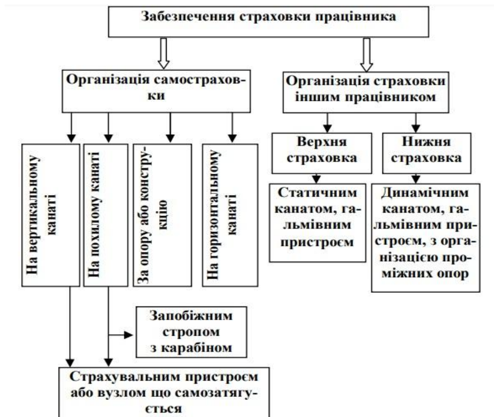
Рисунок 5.3 – Загальна схема організації страховки та самостраховки
