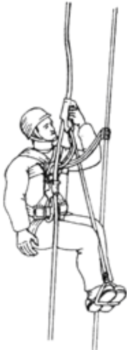
Рисунок 6.2 – Спосіб підйому «коліно-стопа»
