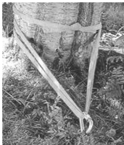
Рисунок 4.5 – Петля з подвійним обертом
