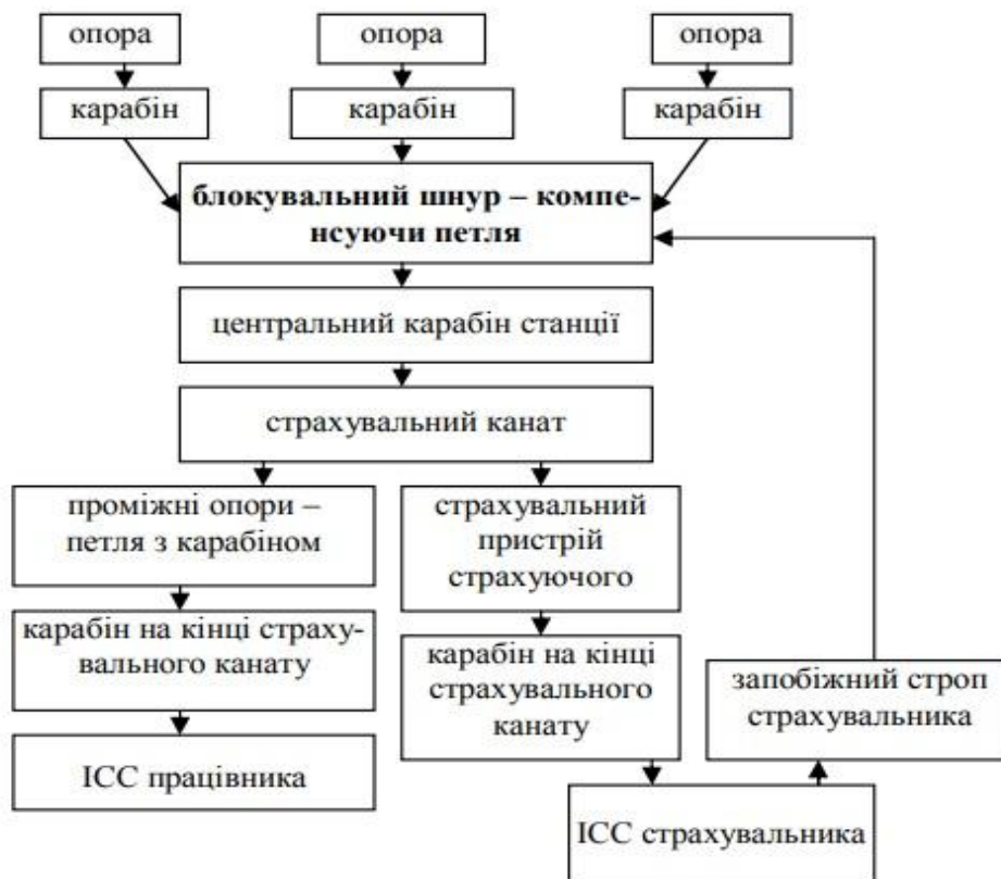
Рисунок 5.2 – Приклад страхувальної ланки при підйомі по елементах конструкцій із нижньою страховкою
