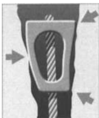
Рисунок 4.22 – Принцип розклинення закладного елемента в щілині
