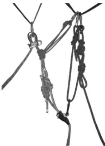
Рисунок 7.9 – Встановлення другого страхувального пристрою
