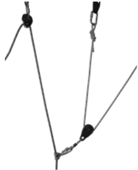
Рисунок 7.14 – Поліспаст з окремого канату
