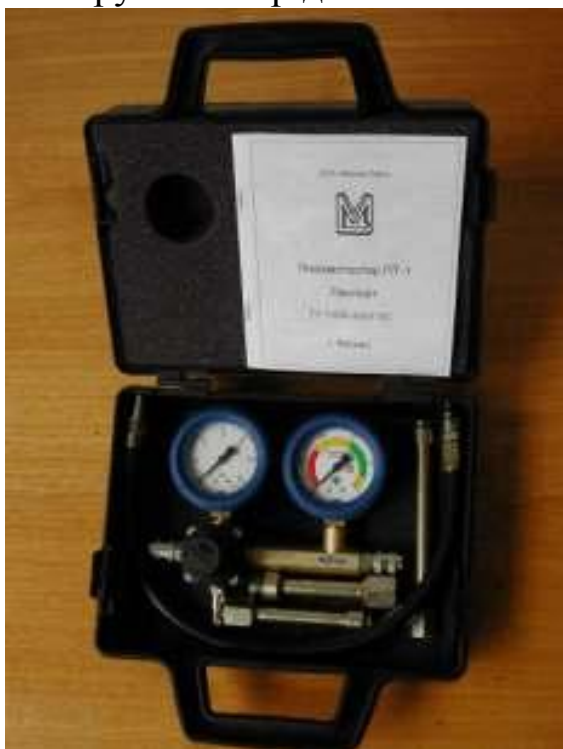
Рисунок 8.19 – Тестер негерметичності надпоршневого простору (пневмотестер)
