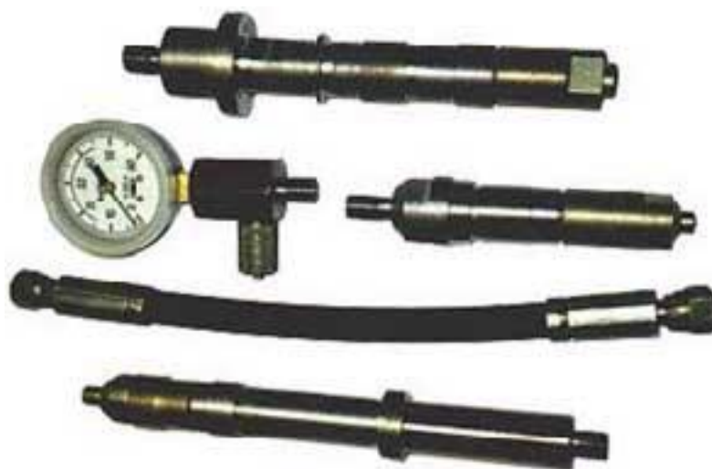
Рисунок 8.6 – Компресометр для дизельних двигунів КМ-201
