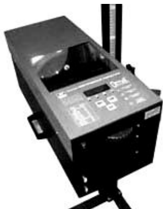
Рисунок 8.2 – Прилад для перевірки та регулювання світла фар ОП
