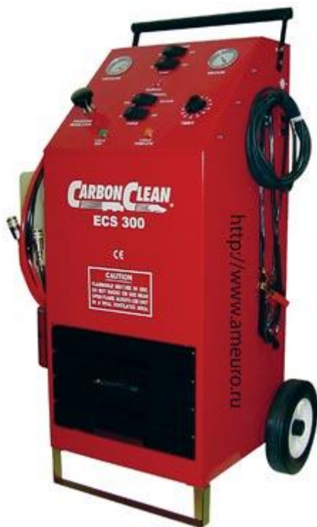
Рисунок 8.15 – Установка для очищення паливних систем бензинових двигунів
