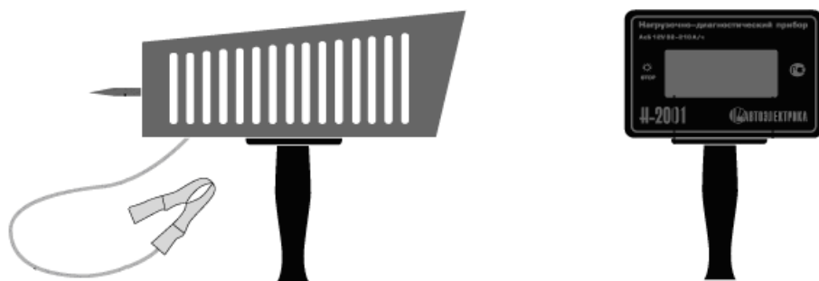
Рисунок 8.5 – Навантажувально діагностичний прилад Н-2001
