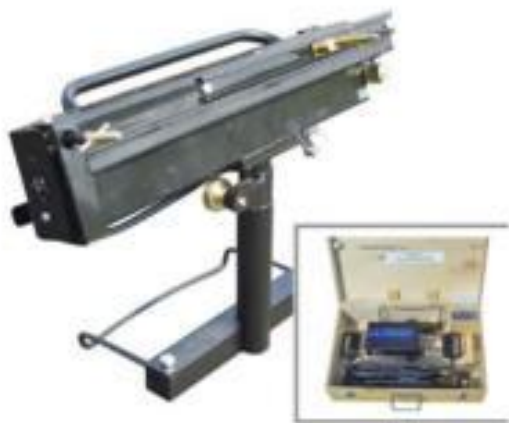
Рисунок 8.4 – Прилад для виміру сумарного люфту рульового керування ИСЛ 401
