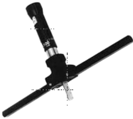
Рисунок 8.1 – Прилад перевірки натягу приводних ременів
