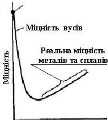
Рис. 4.30 – Залежність міцності кристала від кількості дислокацій (схема за А.А. Бочваром)
