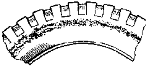
Рис. 2.159 – Зовнішні ознаки кільцевого руйнування бокової стінки шини від взаємного торкання здвоєних шин при роботі
