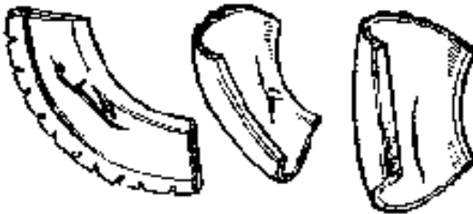
Рис. 2.161 – Наскрізні розриви бокових стінок шин внаслідок вагового перевантаження
